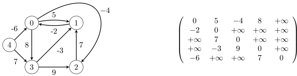
FIGURE 12.1 – Un graphe pondéré et sa matrice d'adjacence
